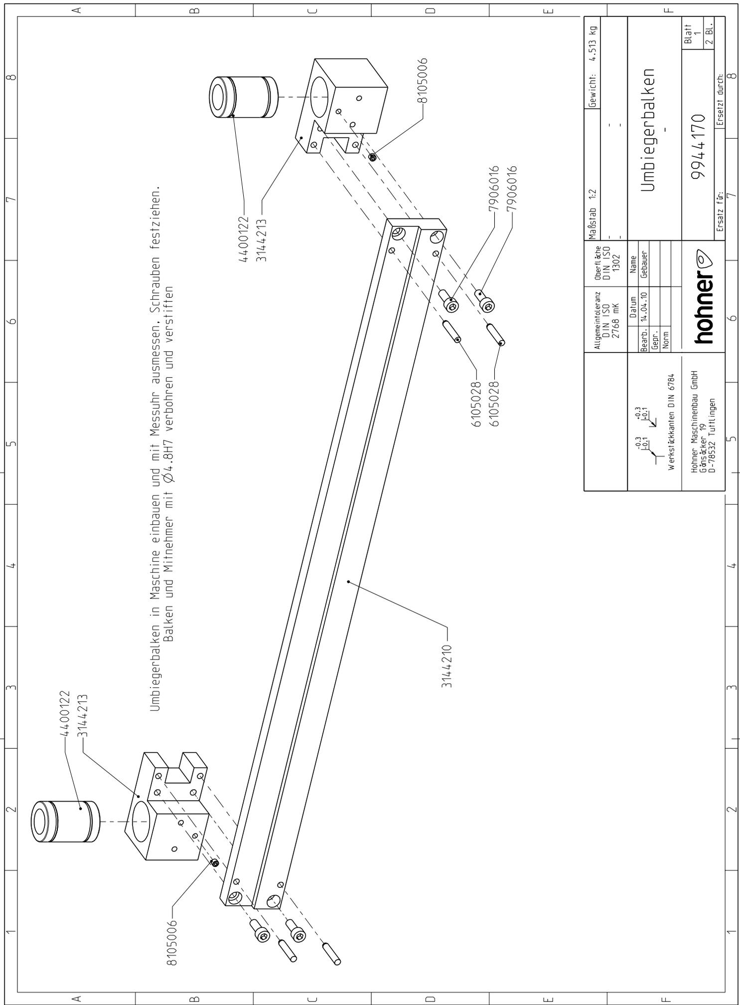
Umbiegerbalken in Maschine einbauen und mit Messuhr ausmessen, Schrauben festziehen.
